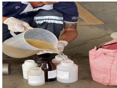
ภาพที่ 2.2-10 การเก็บตัวอย่างคุณภาพน้ำทั้งก่อน-หลังการบำบัดภายในอาคารจอดแล้วจร
