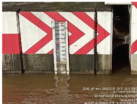
ภาพที่ 2.2-20 บรรทัดน้ำบริเวณต่อม่อสะพานรถไฟฟ้า
